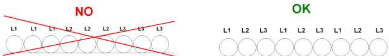
Рис. 17 - прокладка проводов питания большой длины
